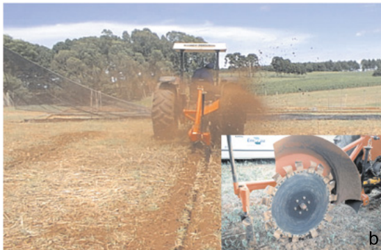
Figura 6.10 - (a) Máquina utilizada para a abertura dos sulcos para o vertical mulching , (b) valetadeira rotativa produzida pela SEMEATO S.A. (RIGHES et al., 2002).
